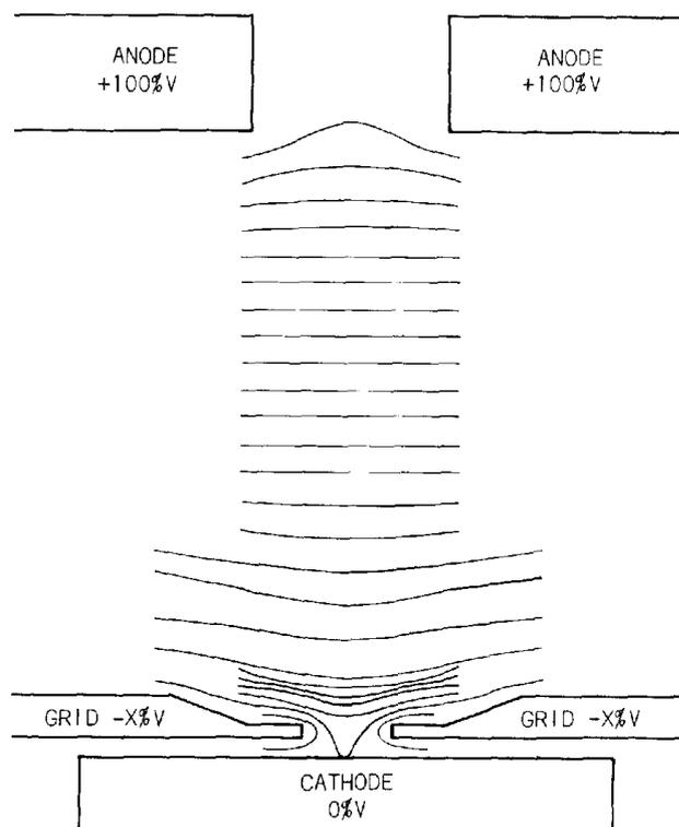
Fig. 3-5. Cathode/anode equipotential line plot.
