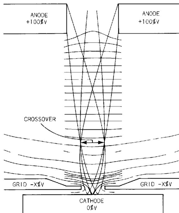
Fig. 3-3. Cathode/anode equipotential line plot.
