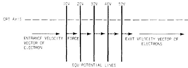
Fig. 2-2. Normal equipotential lines.
