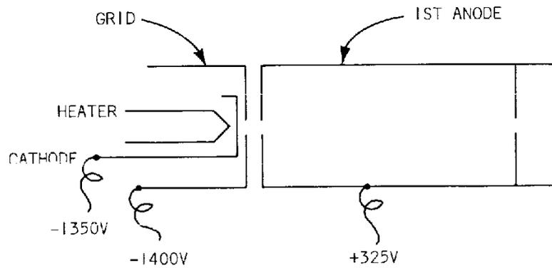
Fig. 3-2. CRT triode (electrical).
