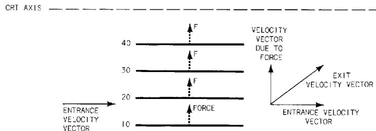
Fig. 2-3. Parallel equipotential lines.
