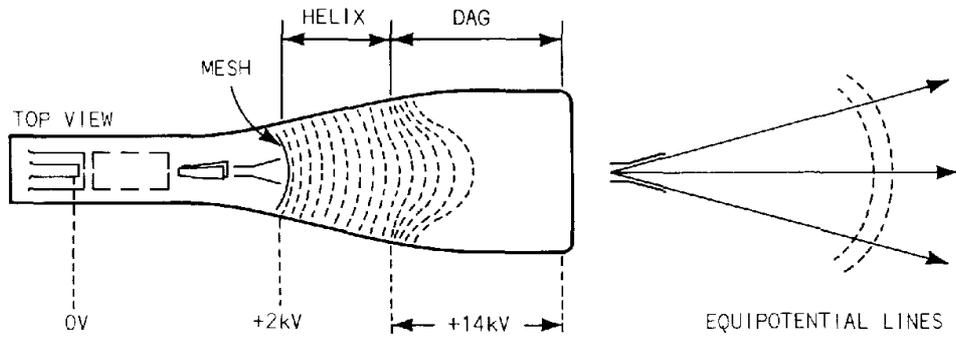
Fig. 7-4. Mesh-type CRT.
