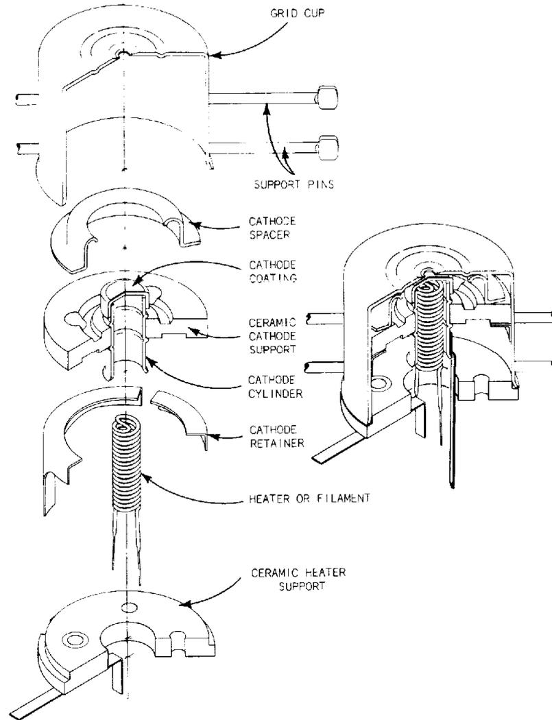
Fig. 3-1. CRT triode (physical).
