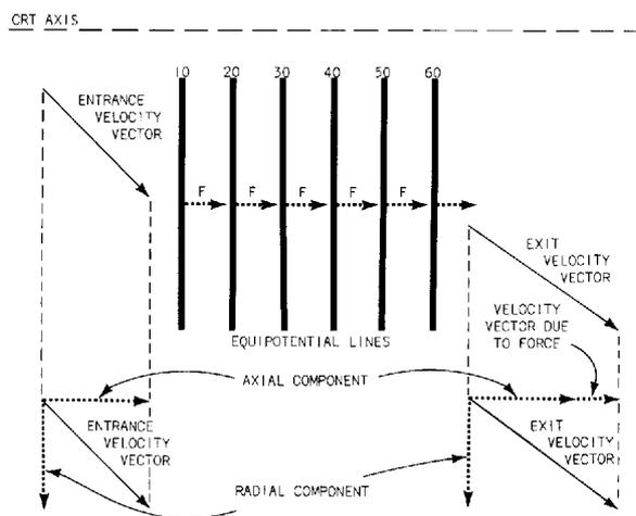
Fig. 2-4. Equipotential lines at an angle.
