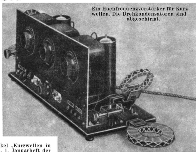
Ein Hochfrequenzverstärker für Kurzwellen. Die Drehkondensatoren sind abgeschirmt.
