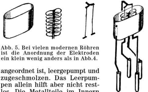
Abb. 5. Bei vielen modernen Röhren ist die Anordnung der Elektroden ein klein wenig anders als in Abb. 4.
