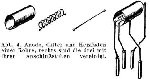
Abb. 4. Anode, Gitter und Heizfaden einer Röhre; rechts sind die drei mit ihren Anschlußstiften vereinigt.
