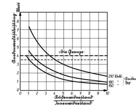
Abb. 2. Die Anodenverlustleistung für verschiedene Anodenspannungen abhängig von dem Widerstandsverhältnis.
