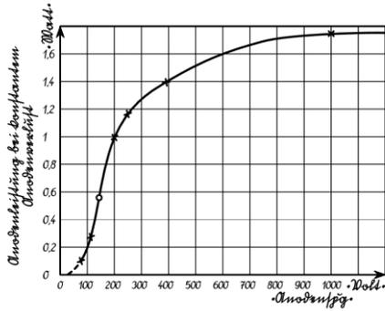
Abb. 4. So steigt die abgebbare Leistung mit wachsender Anodenspannung. 1000 Volt wind man die Röhre zwar nicht zumuten können. Aber man sieht, daß bereits in erträglichen Grenzen der Anodenspannungserhöhung die Leistung wesentlich steigt. Die Grenzen müßten experimentell festgelegt werden. Sie liegen jedenfalls höher, als die in den Listen angegebene Anodenspannung.
