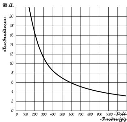
Abb. 5. Wie der Anodenstrom bei höherer Anodenspannung zurückgeht.
