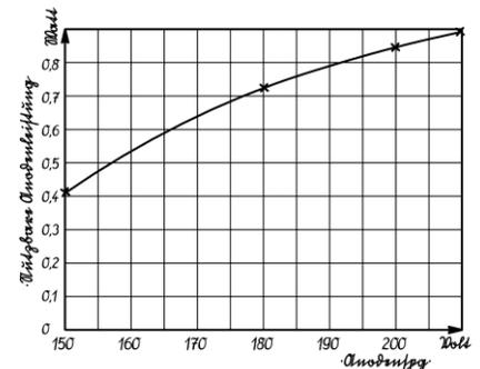
Abb. 3. Wie die Leistung hier mit zunehmender Anodenspannung steigt. (Die Anodenverlustleistung ist konstant.)
