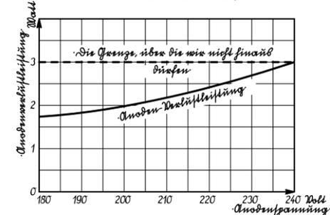
Abb. 1. So steigt die Anodenverlustleistung für konstanten Außenwiderstand, wenn wir die Anodenspannung erhöhen.
