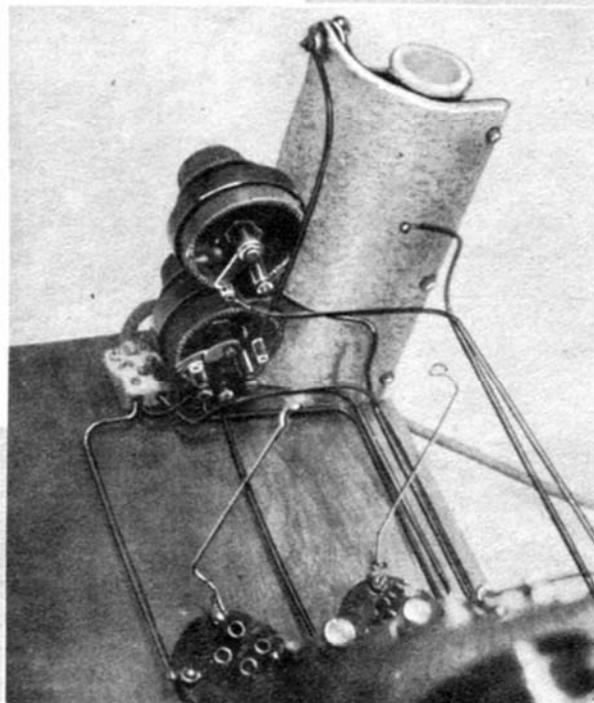
Die Leitungen zum Regulierwiderstand und zum Potentiometer. Hinter der Asbestwand der große Vorwiderstand R1. Beachte die Stifte am Drehwiderstand R2 (unten), die ein Überheizen und in vollständiges Ausschalten beim Einregulieren verhindern.
