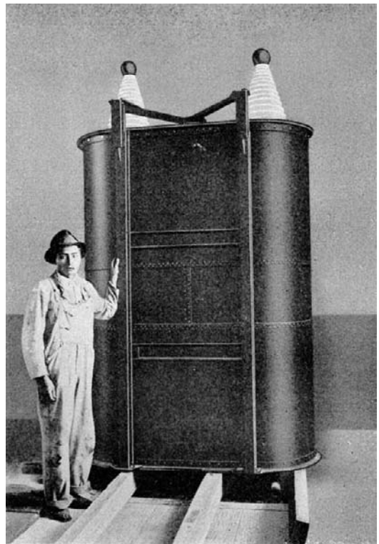
Bild 14. Hochspannungs-Transformator von 100000 Volt
