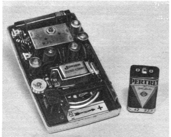
Bild 2. Innenansicht des 6 - Transistoren - Taschen - Supers Telefonen TR 1, daneben die 22,5-V-Batterie
