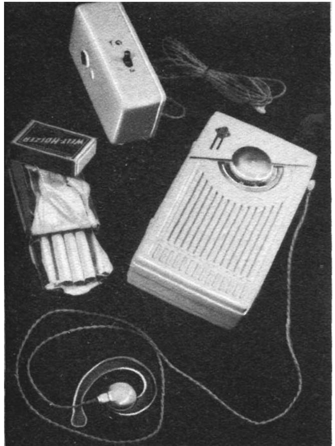
*Bild 3. Transistor-Taschen-Super Telefunken TR 1; links oben das Netzgerät*
