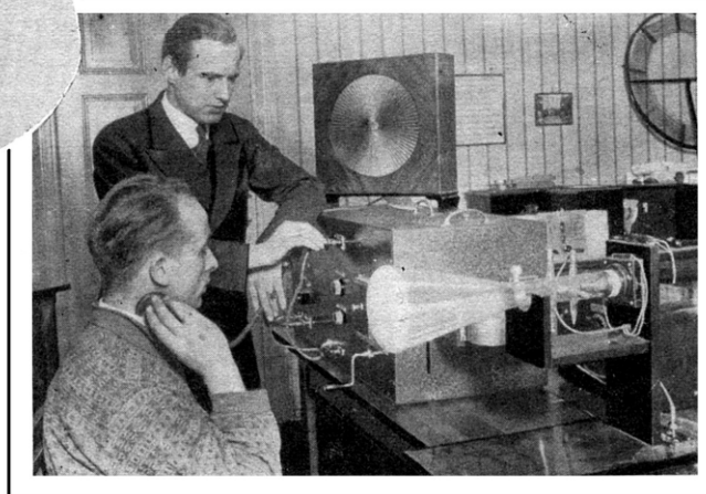
O b e n : Das Spezial- mikrophon zum Abhören der Lungengeräusche.
