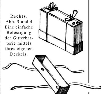
Rechts: Abb. 3 und 4 Eine einfache Befestigung der Gitterbatterie mittels ihres eigenen Deckels.
