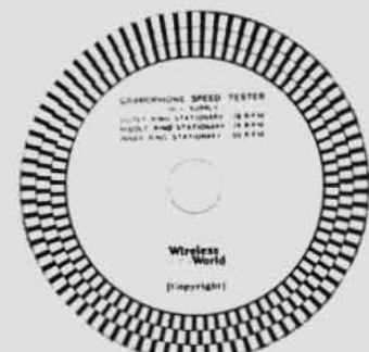
Abb. 1. Eine Anordnung zur Kontrolle der Umdrehungszahl des Grammophonplattentellers.
