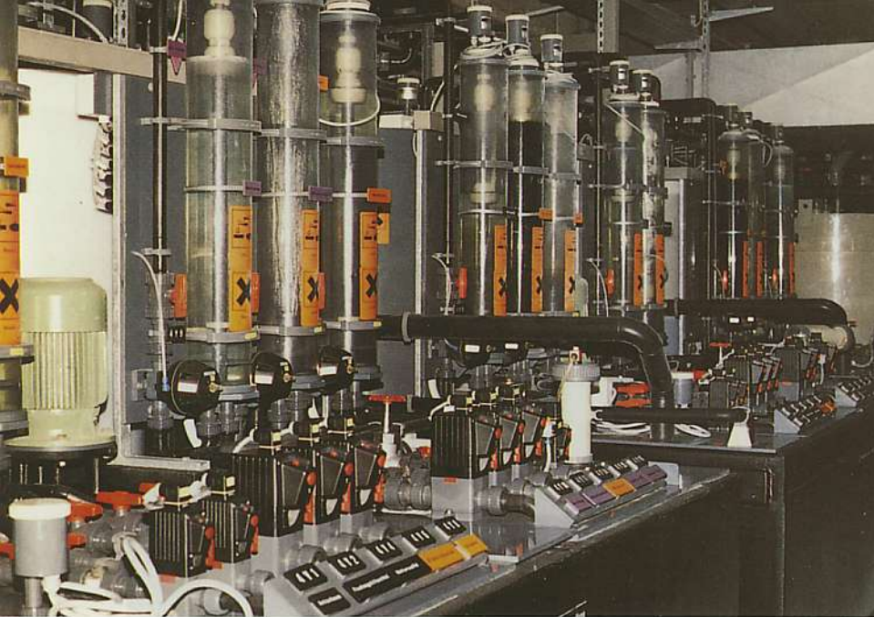
Umweltschonende Herstellung und recycling-gerechte Produkte sind bei Rohde&Schwarz längst selbstverständlich: So wird im Werk Teisnach das gesamte Brauchwasser gereinigt und wieder dem Produktionsprozeß zugeführt
