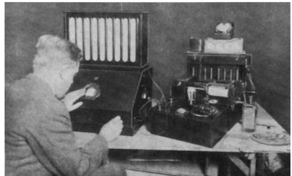
Abstimmung des Empfängers auf die Welle von Königswusterhausen. Rechts von dem großen Empfangsgerät der Bildschreiber mit dem Relais. — Phot. Scherl
