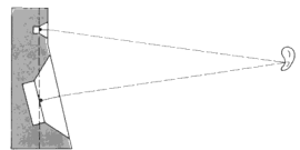
Bild 17. Aufbau einer Lautsprechergruppe unter dem Gesichtspunkt, die Laufwege für den Schall zwischen Lautsprecher und Ohr möglichst gleich zu machen [2]
