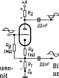
**Bild 2. Phasenumkehrstufe mit einer Triode**
