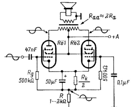
Bild 5. Prinzipschaltung der katodengekoppelten Gegentakts-Endstufe
