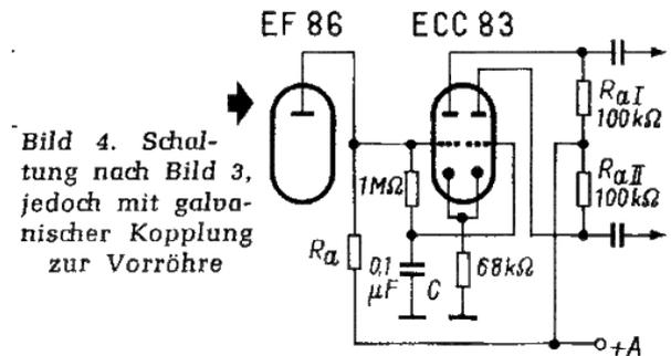
Bild 4. Schaltung nach Bild 3, jedoch mit galvanischer Kopplung zur Vorröhre
