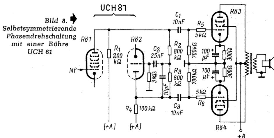
Bild 8. Selbstsymmetrierende Phasendreherschaltung mit einer Röhre UCH 81
