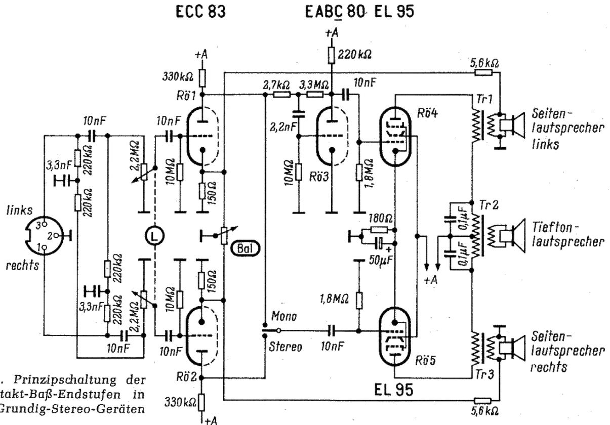
Bild 9. Prinzipschaltung der Gegentakt-Baß-Endstufen in den Grundig-Stereo-Geräten
