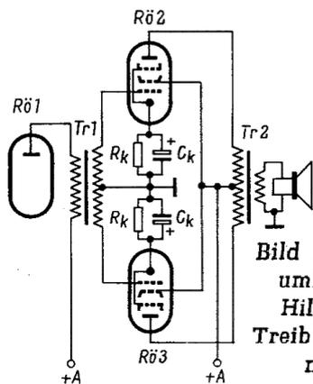
**Bild 1. Phasenumkehr mit Hilfe eines Treibertransformators**
