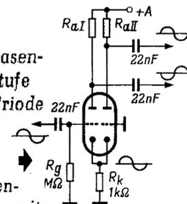
**Bild 3. Phasenumkehrstufe mit einer Doppeltriode**
