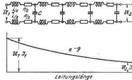
Die Dämpfung auf einer Doppelleitung (Paralleldraht- oder konzentrische Leitung) ist gegeben durch:
