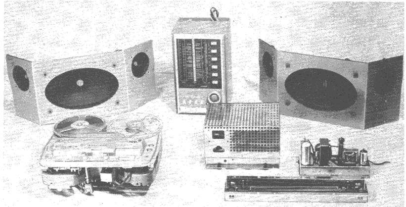
*Bild 1. Bausteine der Grundig-Hi-Fi-Stereo-Serie. Hinten: links und rechts die Teile der Lautsprecherkombination LS 21; in der Mitte das Empfangs- und Bedienungsteil HF 1; vorn links das Einbau-Tonbandgerätechassis TM 45, vorn in der Mitte der Hi-Fi-Stereo-Endverstärker NF 2; vorn rechts die Nachhallrichtung HS 1/HV 1*
