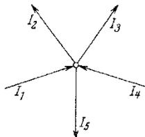
Bei den zu bestimmenden Strömen und Spannungen kann die Richtung zunächst beliebig angenommen werden. Ergibt sich aus der Rechnung der (die) gesuchte Strom (Spannung) mit negativem Vorzeichen, so bedeutet das, daß er (sie) der angenommenen Richtung entgegengesetzt gerichtet ist.
