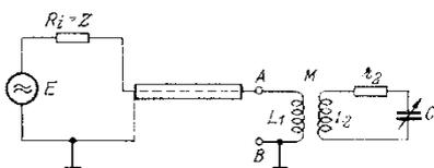
Bild 20. Kabel mit Schwingkreis als Abschluß
