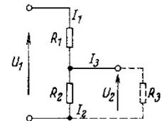
Bild 3. Spannungsteiler, Dimensionierungs-Beispiel
