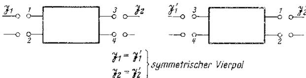
Bild 6. Symmetrischer Vierpol, Vertauschen von Ein- und Ausgangsklemmen
