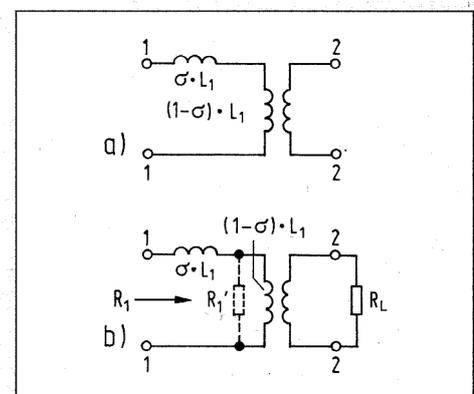
⑩ a) Bei Streuung teilt sich die Gesamtinduktivität z. B. im Eingangskreis auf die Teilinduktivität  $\sigma \cdot L_1$  und die Restinduktivität  $(1 - \sigma) \cdot L_1$  auf. b) Die Streuung z. B. im Eingangskreis hat Einfluß auf den Frequenzgang und die Eingangsimpedanz.
