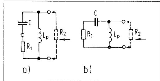
①9 Transformationschaltung mit zwei Blindwiderständen; a) entstanden aus der Schaltung Bild 17b, b) umgeformt in die L-Schaltung.
