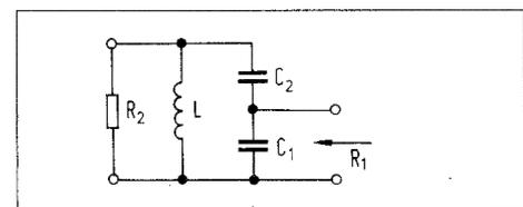
⑮ Die Definitionsschaltung zur Bestimmung der Bemessungsformeln für eine Anpaßschaltung mit kapazitiver Spannungsteilung.
