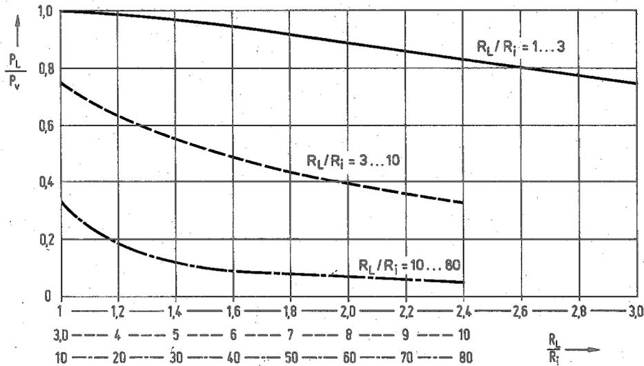
**(3) Diagramm für das Verhältnis  $P_L$  (Klemmenleistung) zu  $P_v$  (verfügbare Leistung) in Abhängigkeit von der Fehlanpassung  $R_L/R_i$  (siehe Gleichung (2)). Um die Werte  $P_L/P_v$  besser ablesbar zu machen, gilt jede der drei Kurven für je eine der drei unterschiedlichen Abszissenteilungen.**
