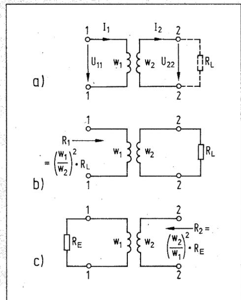
⑧ Anpassung mit einem HF-Übertrager; a) dient zur Definition von  $\ddot{u}_U$  und  $\ddot{u}_I$ , b) dient zur Erläuterung von Gleichung (7), c) dient zur Erläuterung von Gleichung (8).
