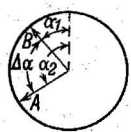
Bild 2. Phasenverschiebung zweier Vektoren
