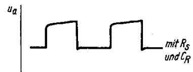
Bild 15. Impulsformverbesserung durch R_s und C_R
