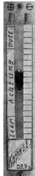
Abb. 3 Kapazi zeigt den Ladezustand unerseres Akkus an
