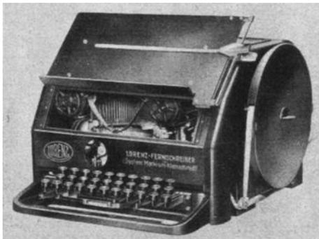
Start - stop - Fernschreiber (System Morkrum-Kleinschmidt; von Lorenz. Der Fernschreiber, ein Telegraphenapparat, gestattet Typenschrift auf nur zwei Leitungen zu übertragen. Der Apparat findet im Flugdienst zum Verkehr der Bodenstationen untereinander Verwendung.
