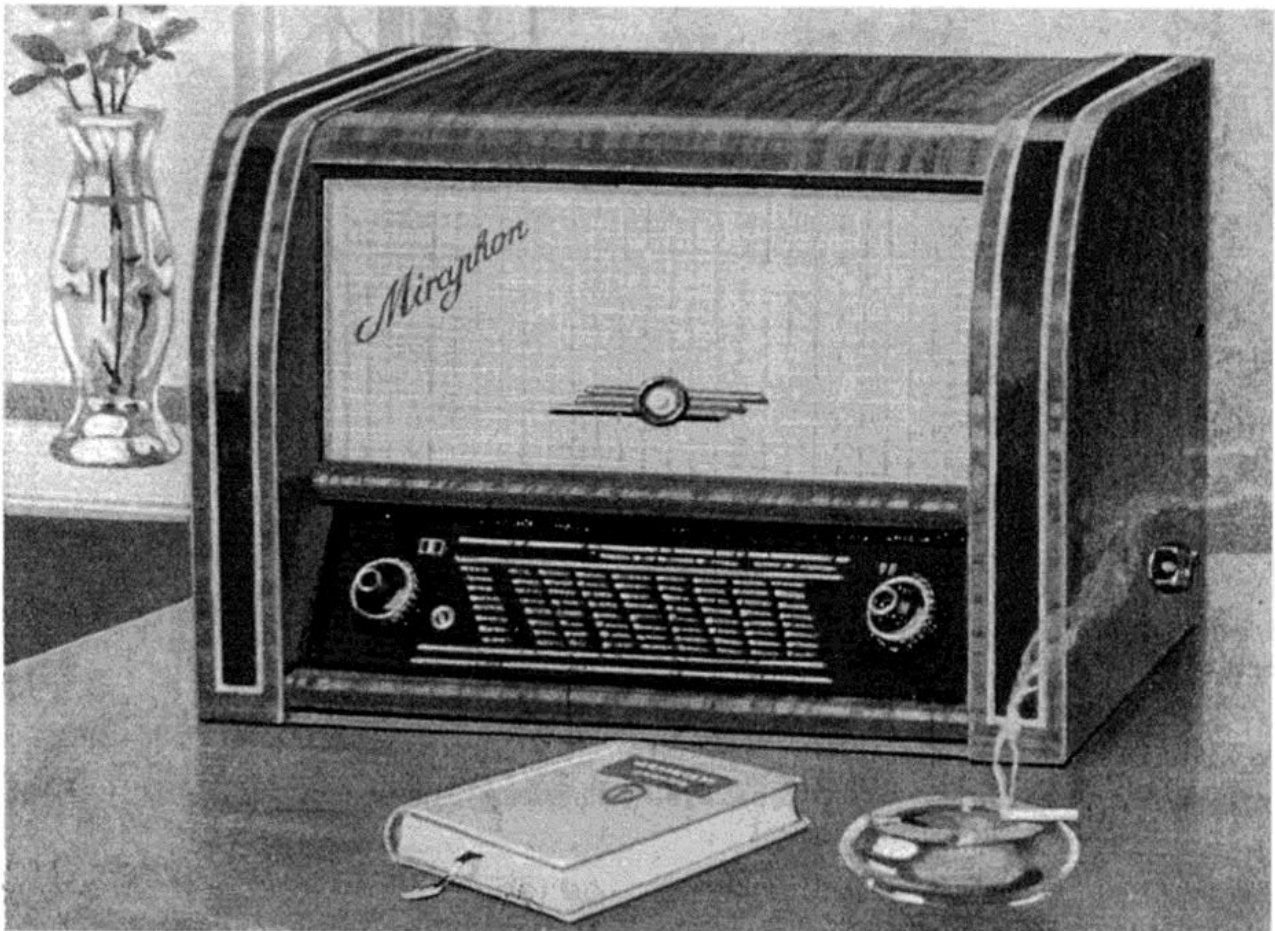
Bild 2: EMW "Miraphon" mit UKW. Röhren: ECH81, 6SH7, EBF11, 6H6, EL11, EM11, AZ11
