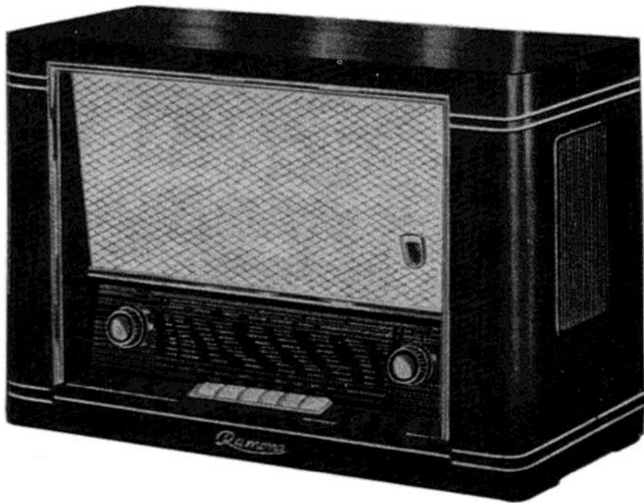
Bild 3: EMW "Ramona", Bj. 1956/57, 7/9-Kreis-Super, Röhren: ECC85, ECH81, EF85, EABC80, EL84, EM80, EZ80
