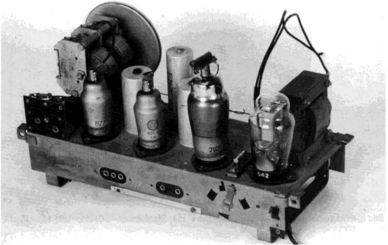
Bild 6: Chassis von Continental in Wechselstromausführung mit Außenkontaktröhren ECH4, ECH4, EBL1, AZ1.
