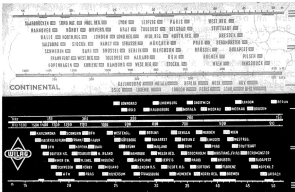
Bild 8: Skalen des Standard-Supers: oben Continental, unten Wilag. Der Kopenhagener Wellenplan ist noch nicht berücksichtigt. Die Mittelwelle reicht von 510 - 1600 kHz, der Frequenzbereich von 1500 bis 1600 kHz ist noch nicht mit Sendern belegt.
