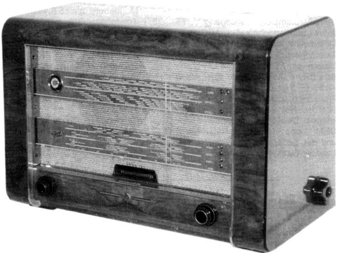
Bild 1: Telefunken T 5001. Das Gehäuse mit den großen Flutlichtskalen vor den Lautsprechern und dem seitlichen Wellenschalter erinnert an die Spitzenempfänger der letzten Vorkriegsjahre.
