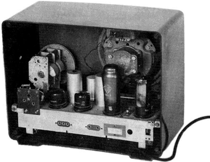
Bild 5: Rückseite des Nora-Standard-Supers mit Stahlröhren UCH11, UBF11, UCL11, UY11
