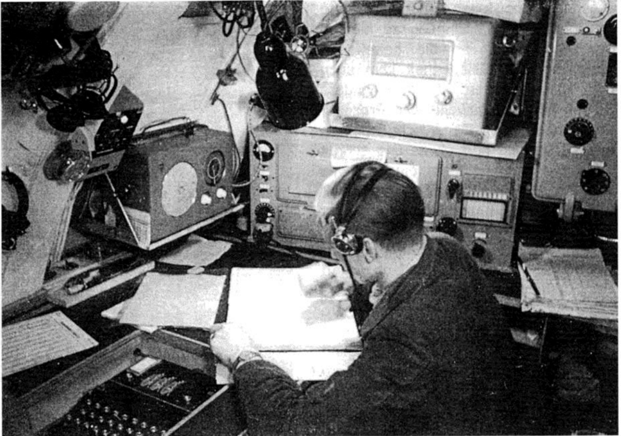
Bild 14: Funkschapp von U 124 (Typ IX B), Aufnahme März 1941, mit den Geräten: GW/KW-6-Kreis-Geradeempfänger Spez.847 S = E 437 S, darüber Ozean-Super, links Radione R2, rechts älterer Peilempfänger, vorn Enigma-Schlüsselmaschine M-3.
