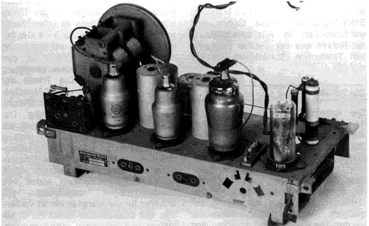
Bild 7: Chassis von Wilag in Allstromausführung mit Außenkontaktröhren UCH5, UCH5, UBL3, UY3.
