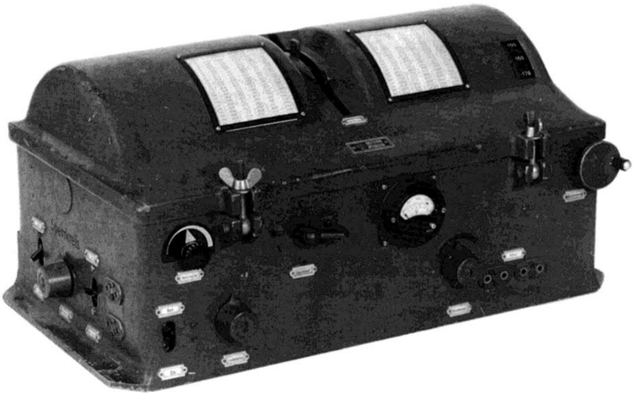
Bild 11: Telefunken-Universalempfänger („Brotkasten“) Spwz.860 Bs (E 381 S). Vier-Röhren-Zweikreis-Geradeausprinzip mit Rückkopplungsaudion. 15 kHz - 20 MHz in 10 Bereichen. Verwendung in ortsfesten oder Schiffs-Funkstationen, für Detektor-Notempfang eingerichtet
