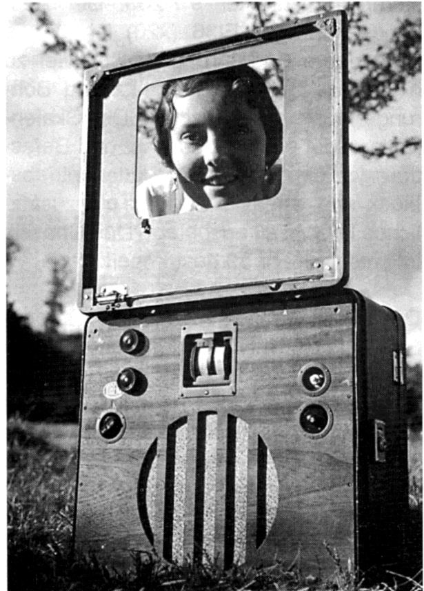
High-Tech 1930: Tragbarer Fernseher mit Flachbildröhre Typ Lorenz 1A30 (Foto F.H. Buhl , Ulm)
