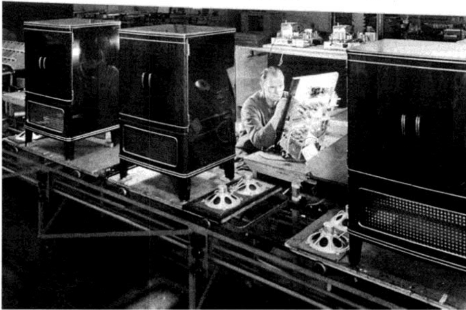
Bild 4: Letzte Vorbereitung vor dem Einbau des Chassis in das Fernsehstandgerät TD 1728 A („Krefeld 5300“, 1957/58)
