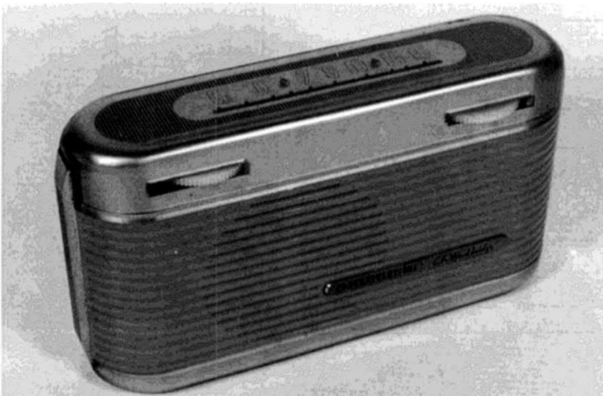
Bild 6: Grundig Mini-Boy, USA- Ausführung (1954/55) Röhren 1V6, 1AH4, 1AJ5, 1AG4.
