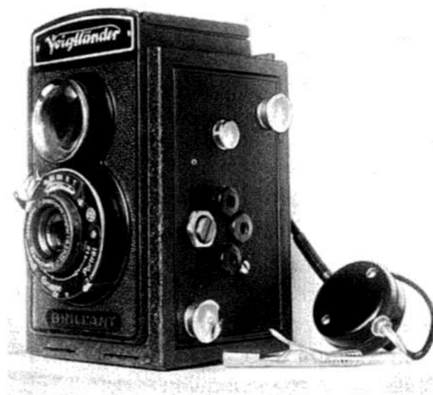
Voigtländer-Kamera mit eingebautem Detektorempfänger, rechts ein Ohrhörer, als Größenvergleich eine Krokodilklemme.
