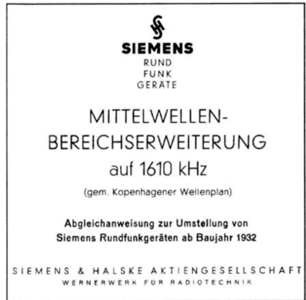
Bild 5: Titelseite der Abgleichanleitung für Siemens-Empfänger nach dem Kopenhagener Plan. Die von den Firmen angegebenen Frequenzgrenzen sind die des Empfangsbereiches , z.B. 520 - 1610 kHz oder sogar 510 - 1620 kHz. Mit dieser "Reserve" nach oben und unten sollte sichergestellt werden, daß auch alle Sender im Empfangsbereich liegen.
