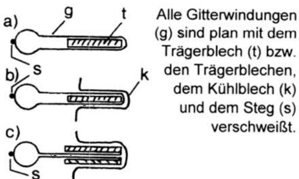
Bild 11: Schematische Darstellung der verschiedenen Gitterbauformen (von oben):
