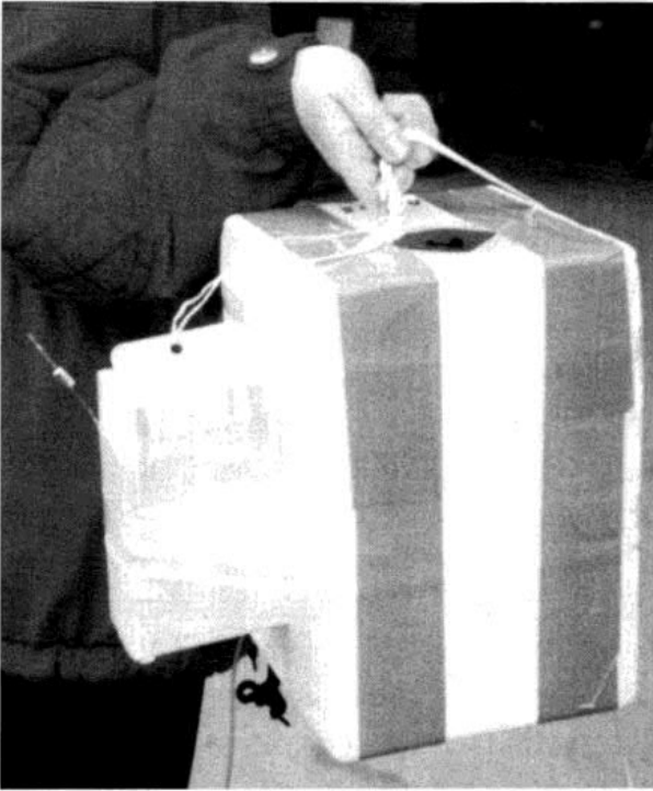
Bild 15: Vaisala-Sonde RS 80 (links, schräg nach oben der Temperatur-/Feuchtefühler) mit Ozonsonde (in Styropor verpackt).
