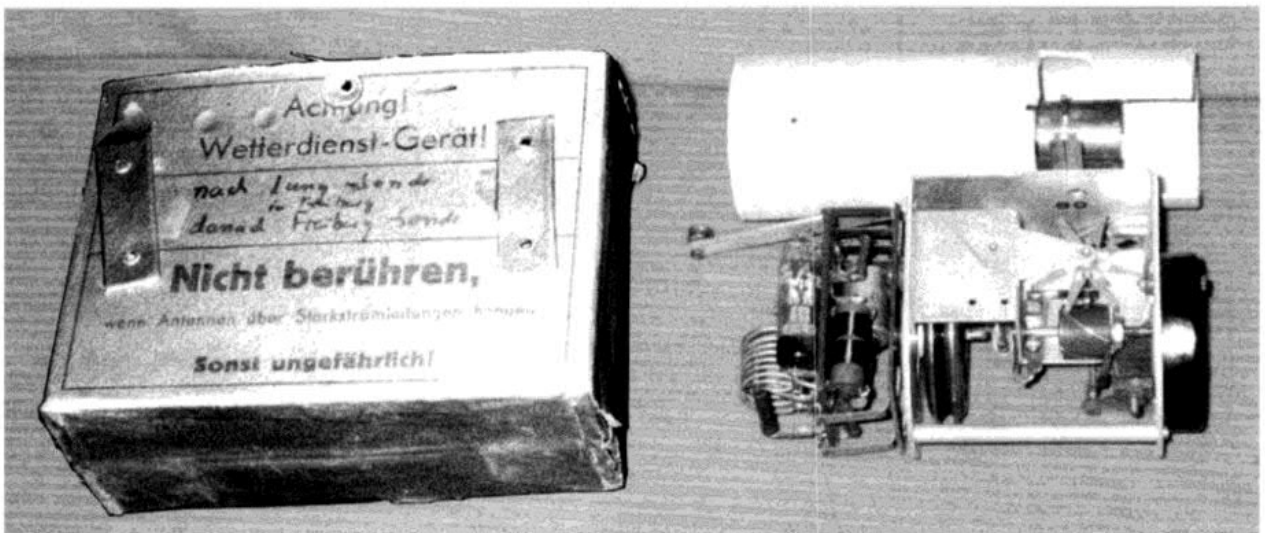
Bild 9: Aus der Lang-Sonde entwickelte Radiosonde Typ "Freiberg", die am Observatorium Lindenberg ab 1957 im Einsatz war [7].
