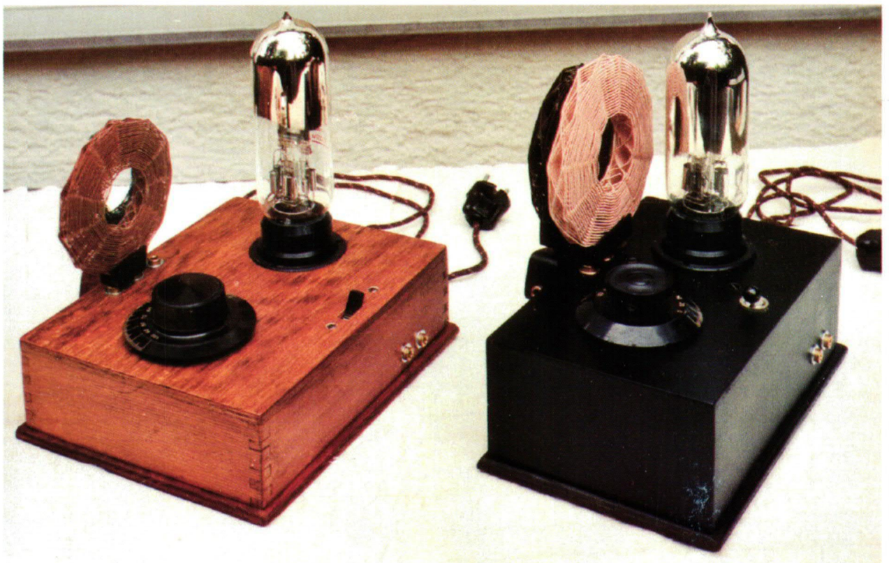
Zum Beitrag auf Seite 277: Nachbildung des Loewe OE 333, an ein Netzteil angeschlossen. Bild unten: Rekonstruktionen des OE mit Rückkopplung und mit eingebautem Netzteil.
