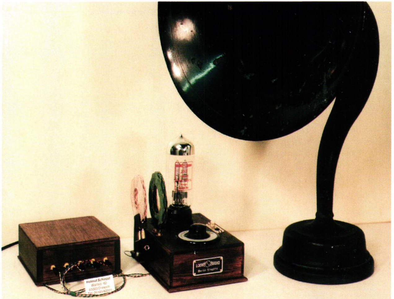
Zum Beitrag auf Seite 277: Nachbildung des Loewe OE 333, an ein Netzteil angeschlossen. Bild unten: Rekonstruktionen des OE mit Rückkopplung und mit eingebautem Netzteil.
