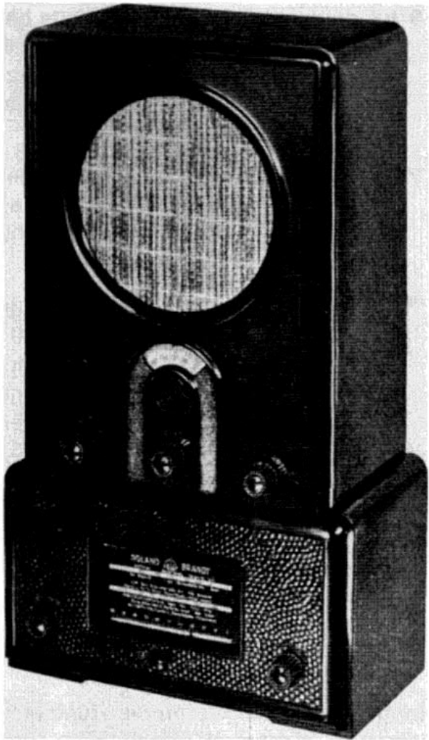
Bild 3.3: Volksempfänger-Vorsatzgerät zur Verbesserung des Empfangs auf Mittel- und Langwelle der Firma Roland Brandt. Ähnliche Geräte wurden auch von Körting und Braun angeboten.
