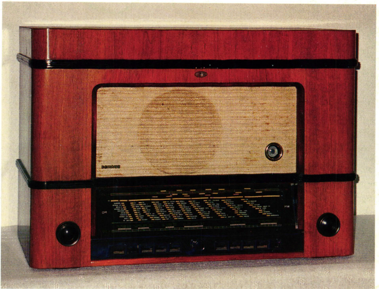
Recordophone T 22 (1949) geschlossen. Nach Heben des Deckels wird das Drahttongerät zugänglich (unten). Zum Beitrag auf Seite 48.
