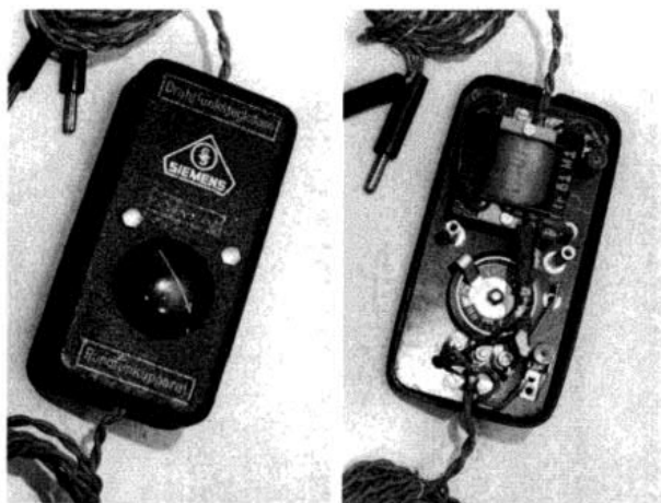
Bild 8: Das "Drahtfunkvorsatzgerät" für den Anschluss an die TA-Buchsen enthielt einen Trenntrafo und ein Lautstärkepotentiometer.
