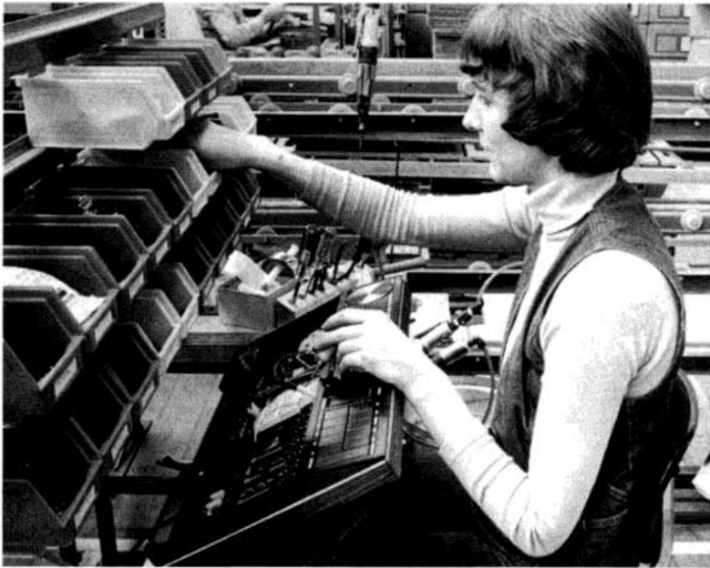
Bild 23: Das Bild von 1977 zeigt den Beomaster 2200 während der Herstellung. Die Bestückung mit Bauteilen wurde von Hand ausgeführt.
