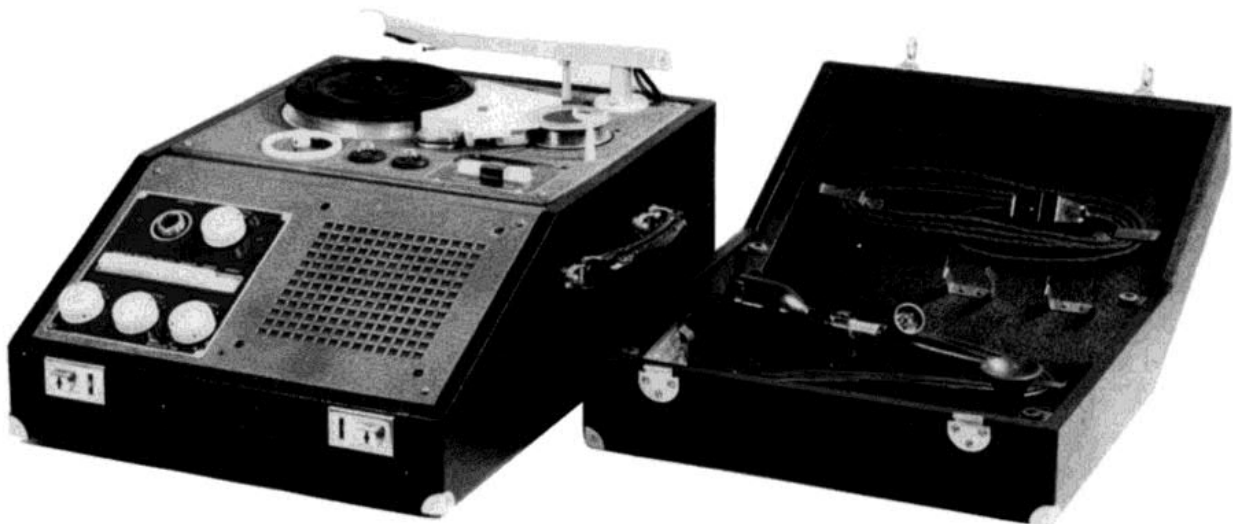
Bild 14: Ein Beocord (aus Bang & Olufsen Recorder ) 506 K aus dem Jahre 1951 für Stahlband und Schallplatten. Bei Bang & Olufsen spürte man immer das Bemühen, die Anlagen zweifach auszunutzen. Oben auf der Stahlbandspule ist ein Teller für Schallplatten und ganz oben ist der Tonarm zu sehen.
