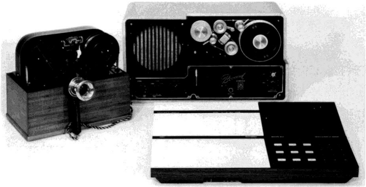
Bild 21: Drei Generationen von Ton-Aufnahme/Wiedergabegeräten. Links ein Tondrahtgerät von Valdemar Poulsen (um die Jahrhundertwende), daneben ein Beocord 84 UG (Drahtwiedergabegerät, 1948), vorn ein Beocord 9000 (Bandgerät, 1981).
