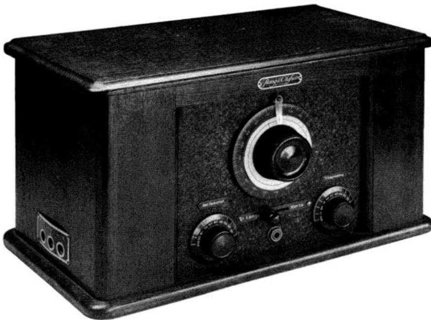
Bild 10: Ein 3-Röhren-Empfänger aus dem Jahre 1927. Oben sitzt der Abstimmknopf, links unten der Knopf zur Antennenkreisabstimmung und rechts die Rückkopplung. In der Mitte unten der Hebel für den Mittel- ("Kurz") oder Langwellenbereich.
