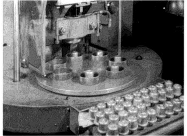
Bild 15: Karussell an der Kolbenschweißmaschine.
