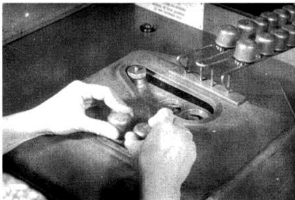
Bild 22: Zinnbad zum Verlöten der Anschlussdrähte mit den Steckerstiften.
