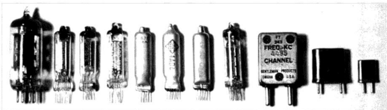
Bild 8: Die in den Geräten PRC-6, PRC-6/6 und FuG 6/FuG 6a verwendeten Röhren (von links nach rechts 3 B 4, 2 G 21, 5676, 5672, 5678, 1 AD 4, DF 61, 6397 spez.) verschiedener Hersteller. Kanalquarze im Halter FT-243 (für BC-611), HC-6/U (für PRC-6) und HC-25/U (für PRC-6/6 und FuG 6/FuG 6a).
