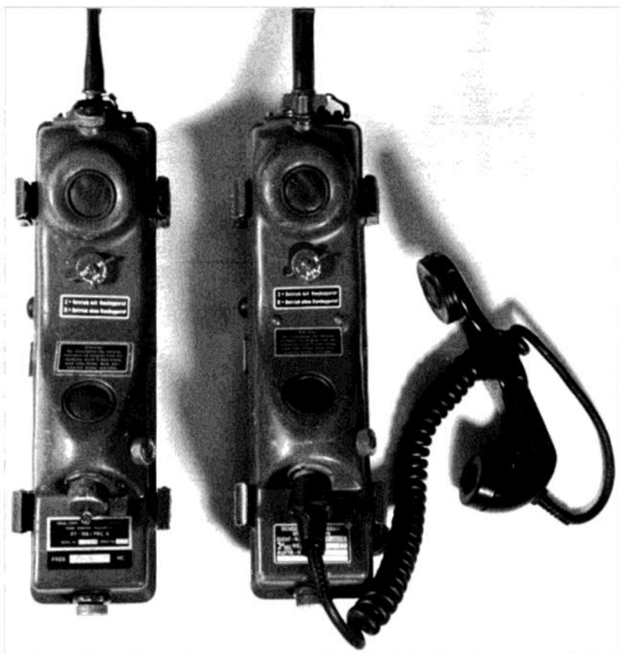
Bild 7: PRC-6 (links) und PRC-6/6 (rechts), dieses mit angeschlossenem Handapparat. Beim PRC-6/6 ist vor dem Antennenfuß der Kanalschalter angeordnet, beim PRC-6 eine BNC-Buchse für eine externe Antenne.
