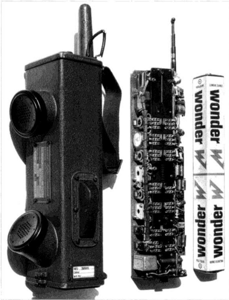
Bild 3: BC-611-F französische Fertigung, Geräteeinschub BC-611 amerikanische Fertigung, Anodenbatterie.
