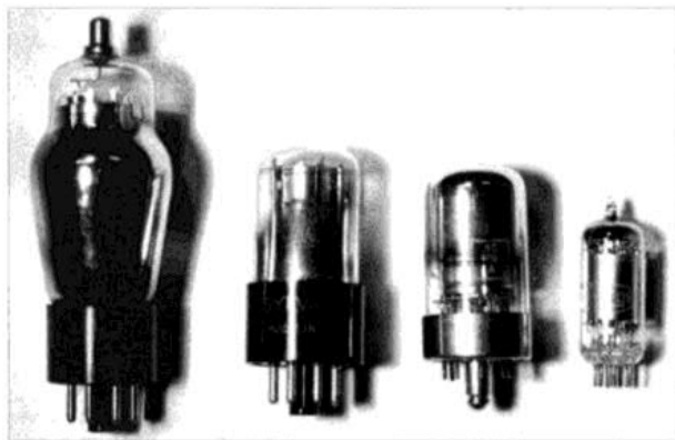
Bild 2: Vergleich der Größe von um 1940 in den USA verfügbaren Batterieröhren mit Oktal- bzw. Loktalsockel mit einer der neuen Miniaturröhren (hier 1 L 4, rechts im Bild).
