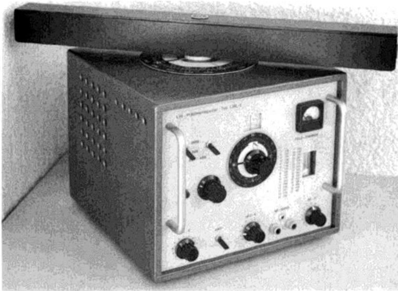
Bild 7: Dritter Empfänger mit Noval-Röhren.
