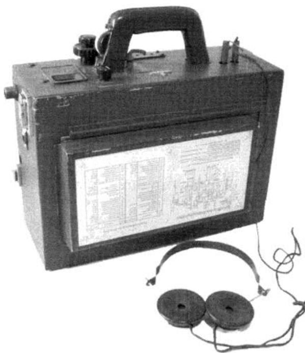
**Bild 1:** *Siemens - Störungssuchgerät, bei der Reichs-Rundfunk-Gesellschaft unter der Bezeichnung „E 4“ eingesetzt.*
