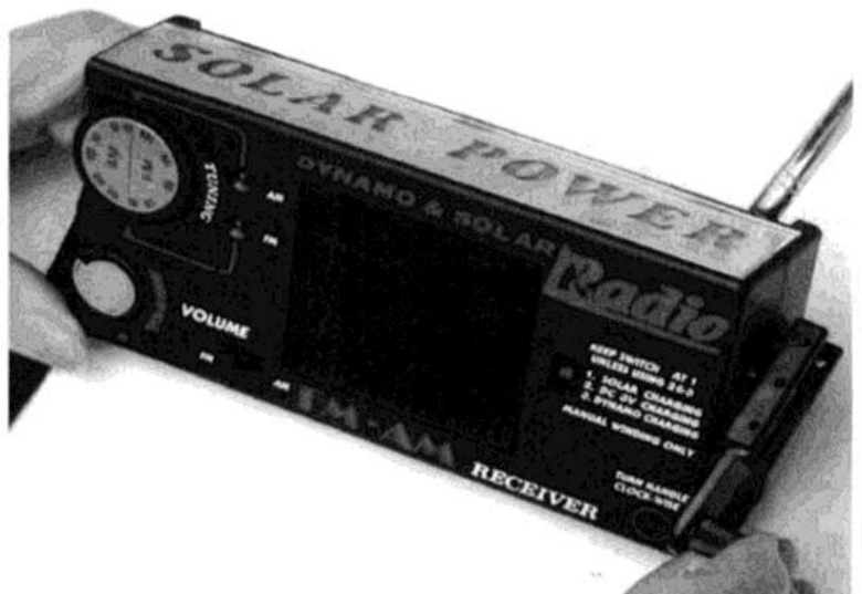
Bild 2: Dynamo und Solar Radio des Elektronik-Händlers Conrad mit Kurbelrad und Dynamo als Energiequelle. Ergänzt ist es mit Solarzelle und Akku, 1998.
