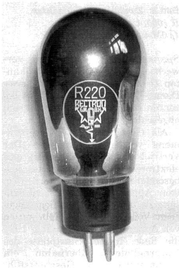
Bild 1: Zweiweg-Gleichrichter R 220, U_f: 2 \times 0,9 \text{ V} , I_f: 2,8 \text{ A} , I_a = 0,2 \text{ A} bei U_{\text{aeff}}: 2 \times 185 \text{ V} , I_a: 1 \text{ A} bei U_{\text{aeff}}: 2 \times 24 \text{ V} .
