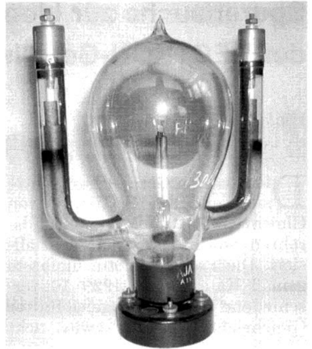
Bild 2: Zweiweg-Gleichrichter R 1000, U_f : 2,1 V, I_f : 4,5 A, I_f : 0,3 A bei U_{eff} : 2 x 1000 V.
