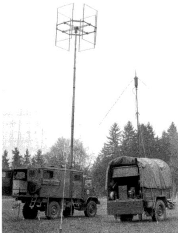
Bild 11: Seriengerät des Horch-/Peil-KFZ 1 - 80 MHz mit VHF/HF-Peilantenne 638/80. SEM-25 mit Funkantenne auf dem Anhänger.
