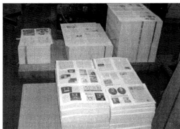
Bild 10: Im Vordergrund die auf Seitengröße geschnittenen Seiten. Die Stapel in der hinteren Reihe warten noch auf ihre Verarbeitung. Ganz links ist auch der Umschlag zu erkennen..
