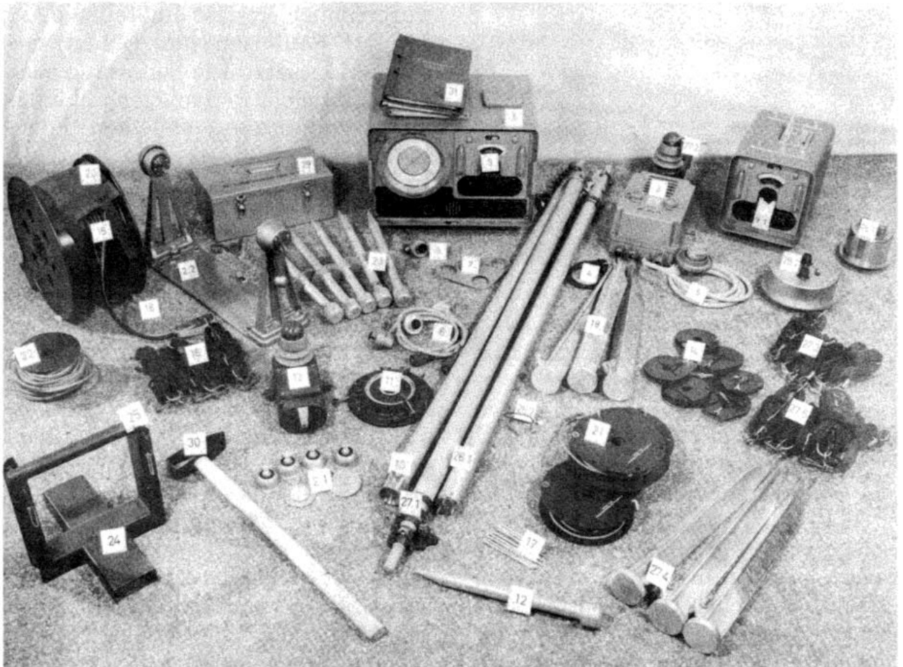
Bild 5: Militärische Aufklärungstechnik ist häufig auch sehr handfest. Auswahl an Einzelteilen, die zu einer Peilanlage SFP 500 gehörten.
