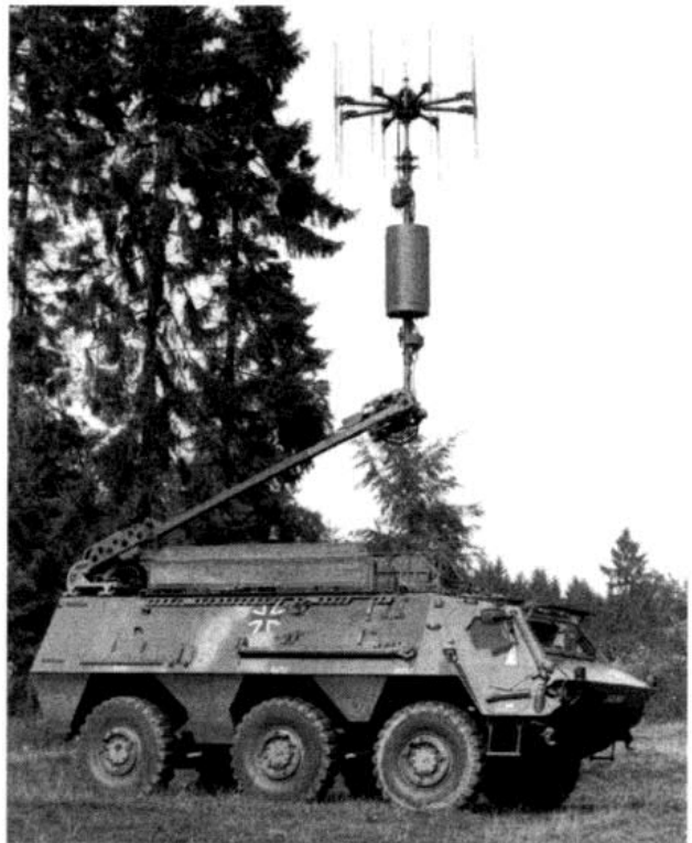
Bild 8: HF/VHF-Peilpanzer (1-200 MHz). Der Antennenmast wurde hydraulisch aufgeklappt und aufgerichtet, dabei entfaltete sich die H-Adcock-Peilantenne 20-200 MHz (für 1-20 MHz musste eine mitgeführte U-Adcock-Peilantenne abgesetzt vom Transportpanzer auf dem Erdboden aufgebaut werden). Der tonnenförmige Behälter am Mast unterhalb der Peilantenne enthielt Schlitzantennen unterschiedlicher Richtung für die UHF-Datenverbindung zur Auswertung.
