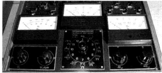
Bild 3: In der Mitte ist der zentrale Drehschalter angeordnet. Links und rechts befinden sich die anderen Regler.
