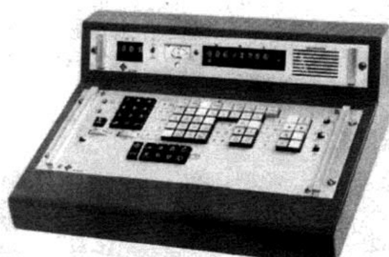
Bild 5: Einzelbediengerät und Zentralbediengerät (zum Bedienen mehrerer abgesetzter Geräte).
