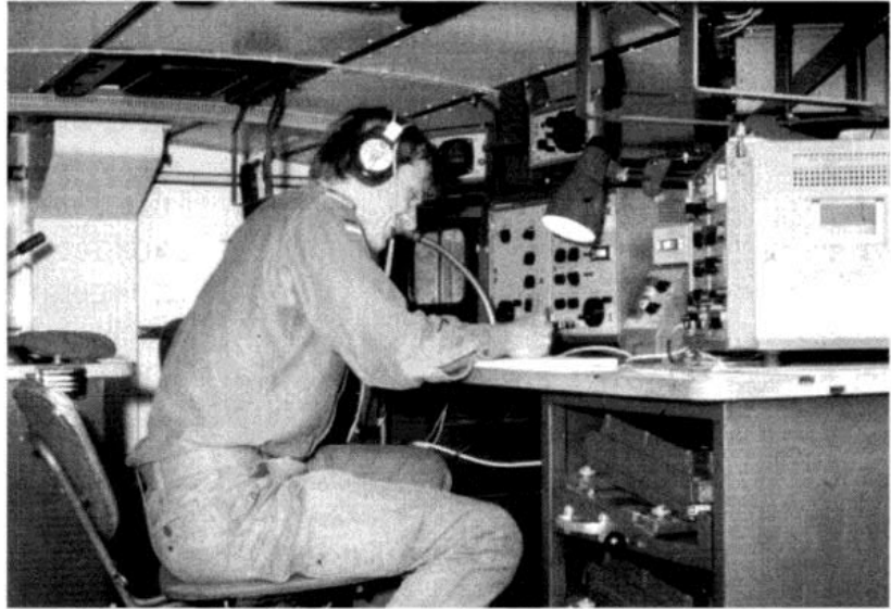
Bild 7: Horcharbeitsplatz des Erfassungsfahrzeugs mit zwei EUK 724, (noch) vier Panoramageräten (eins fehlt) und (im Tischunterbau) zwei Tonbandgeräten M 36, zwischen den Empfängern das Steuergerät für Bandaufnahme und Kopfhörerumschaltung.
