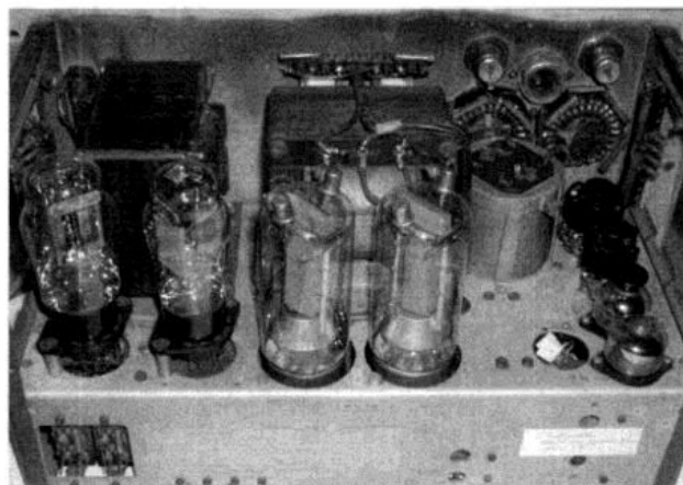
Bild 2: Ansicht von hinten. Sehr schön sind die beiden AZ 12 (links) und die beiden RL 12 P 35 zu erkennen. Rechts sind die Vorstufenröhren.
