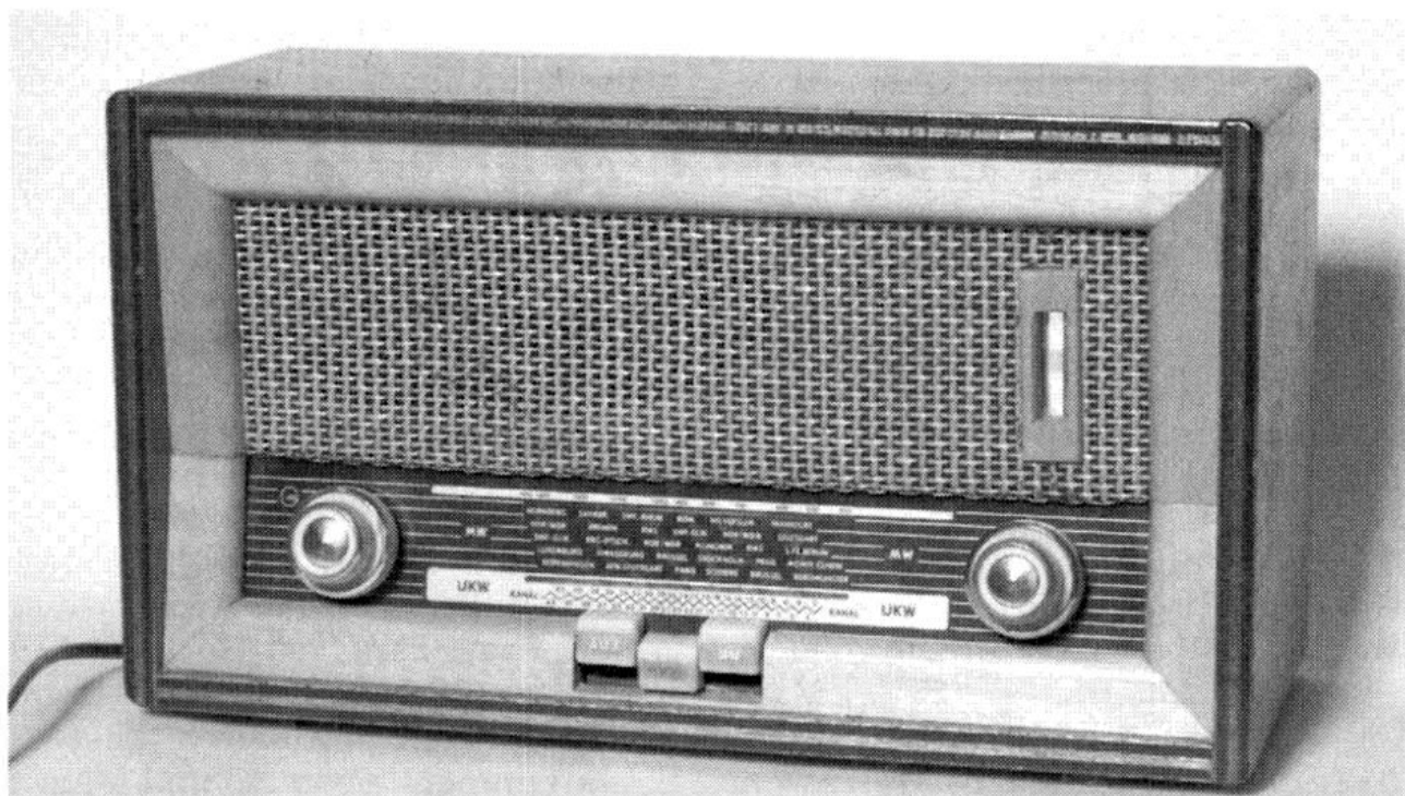
Bild 4: Der Sperrmüll-Grundig in neuem Gehäuse. Rechts in der Schallwand ist die EM 87 eingebaut.
