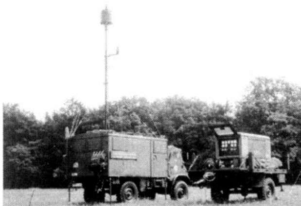
Bild 3: Erfassungsanlage „Luchs/RMB“ der Firma Elettronica (erste Version) mit der Such/Peilantenne und zwei spitzkegligen Breitband-Rundempfangsantennen auf dem ausgefahrenen Kurbelmast, rechts der Stromerzeuger „Multitest“.
