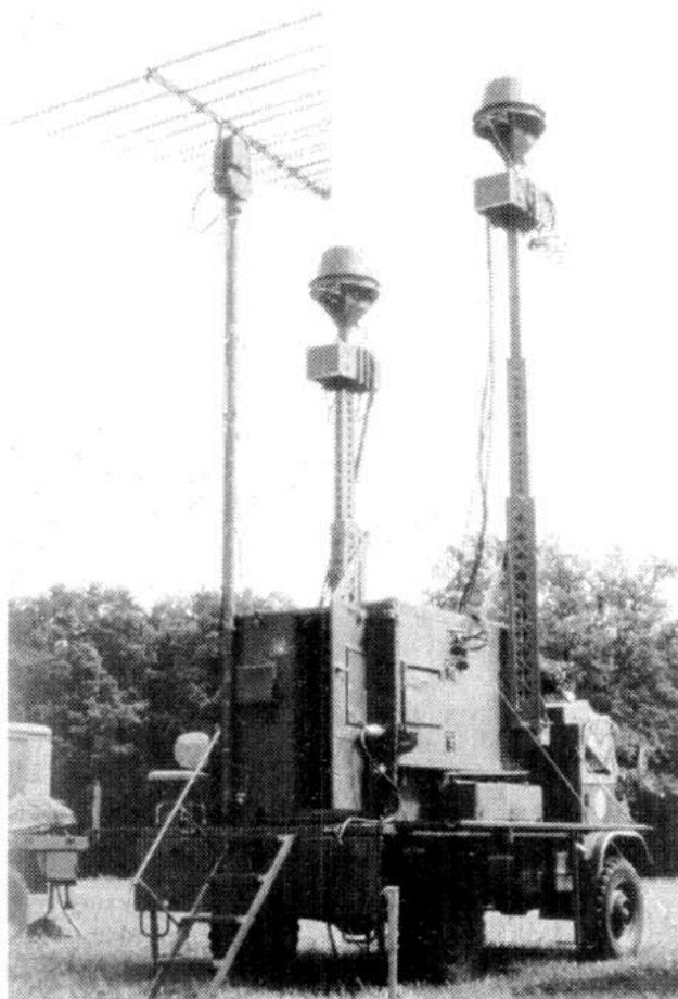
Bild 1: EloAufkl-Anlage AN/MLQ-24 in Shelter auf einem Unimog-Pritschenfahrzeug. Deutlich sichtbar sind die beiden ausfahrbaren Gittermasten mit den Radom-Antennen und Tunern an der Spitze sowie die l/p-Antenne auf dem Steckmast.
