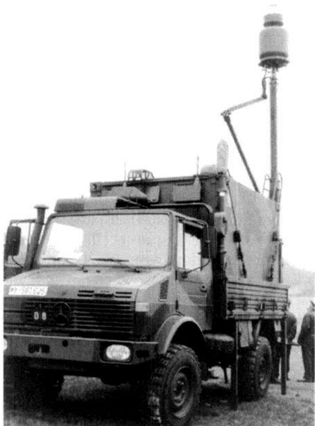
Bild 5: Erfassungsanlage „Luchs/RMB“ der Firma Elettronica (modifizierte Version in Kabine) mit neuer Such/Peilantenne auf dem neuen Mast.
