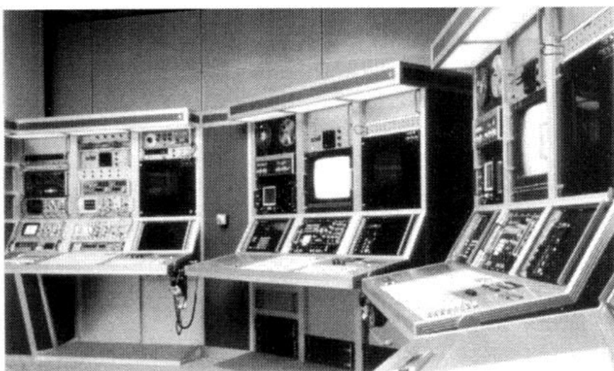
Bild 10: Anlage zur elektronischen Aufklärung WJ 1140/Elekluft in einer der grenznahen Aufklärungseinrichtungen des Heeres. Rechts sind zwei Erfassungsplätze, hinten ein Analyseplatz.
