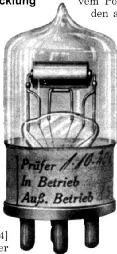
Bild 2: Verstärkertriode RE 11 mit direkt geheiztem Wolframfaden, 1916 im Telefunken-Röhrenlaboratorium entwickelt.
