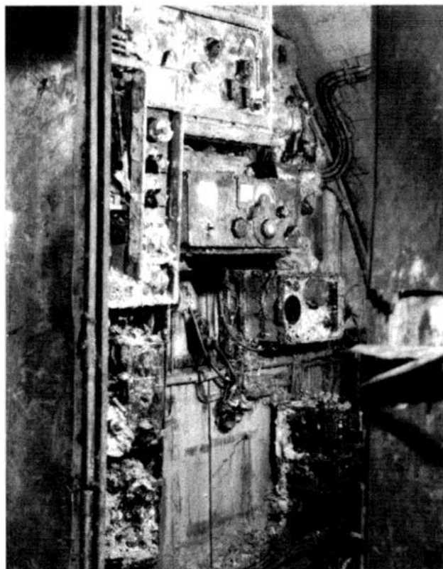
Bild 2: U 3503 nach der Hebung 1946: Blick in den Funkraum, Fahrtrichtung. Links Reste des Senders T 200 FK 39 mit Bediengerät, in der Mitte der Hauptempfänger E 52b-1 oder b-2, Ln 21.000-5/Ln 21.000-6 „Köln“, darüber der Notsender Lo 40 K 39, rechts vermutlich das Tastgerät, rechts unten Restgerät Lo 10 UK 39.
