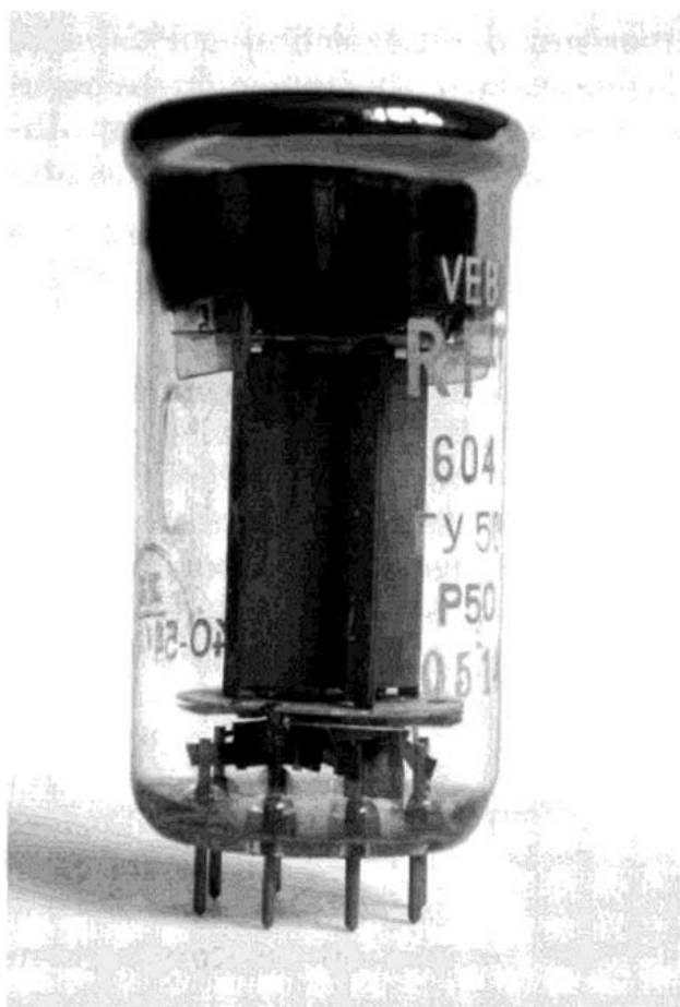
Bild 3: P 50; GU 50. Entspricht äußerlich der russischen Vorbildtype. (604: Schlüsselnummer für WF)
