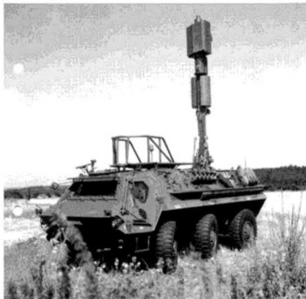
Bild 16: EloAufklärungs panzer „HELAS“ mit hydraulisch aufgerichteter Aufklärungsantenne. Die beiden tonnenförmigen Behälter am Mast unterhalb der Antenne enthalten Schlitzantennen für die UHF-Datenverbindung zur Auswertung
