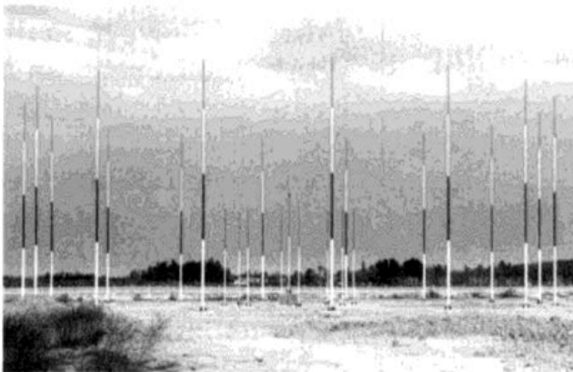
Bild 17: Stationäres Adcock-Antennensystem 0,3-30 MHz mit außen 16, innen acht Antennen. (Werkfoto Plath)
