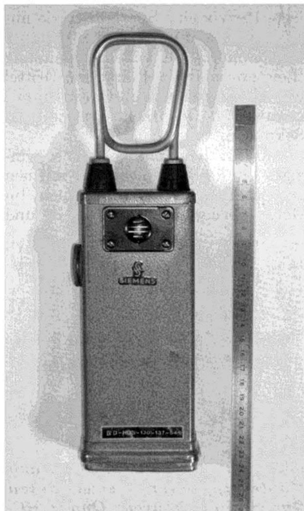
Bild 1: Siemens UKW-Handmikrofon, hier die 2-m-Ausführung mit 50 mW Sendeleistung (Funk 546 S 318 d).
