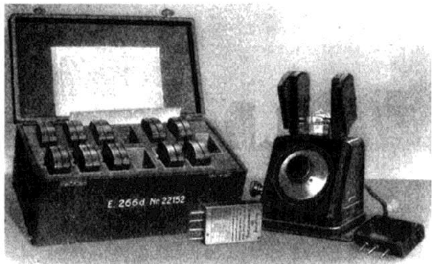
Bild 16: Zubehörkasten des Empfängers E 266 mit Spulensätzen für 7,5-2000 kHz, aus [13].
