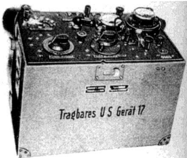
Bild 17: Ältester Röhrensender ARS 60 der „Schützengrabenstation“ (3 W; 545 bis 1200 kHz), aus [20].
