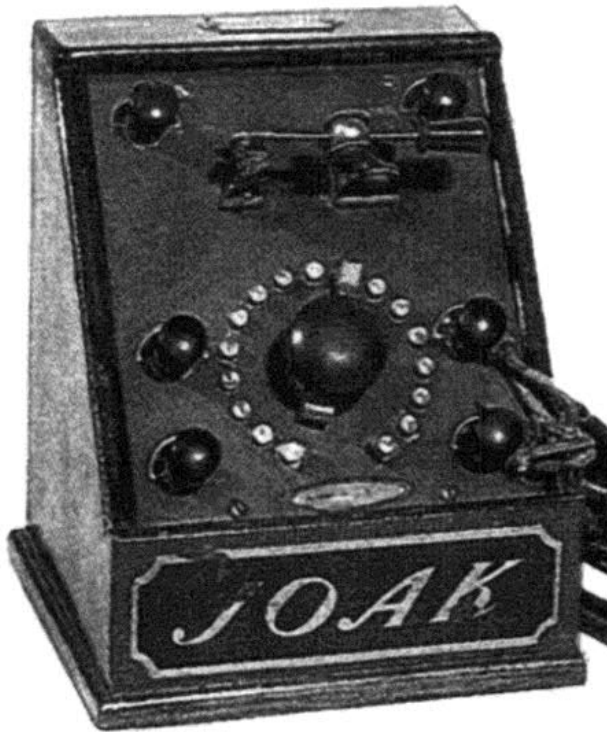
Bild 2: Detektorempfänger, 1925, Nihon Musen Co.
