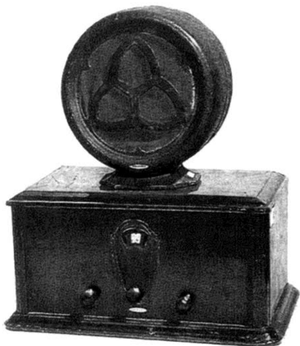
Bild 5: Condor T-100 (Nami-yon), ein Kreis, drei Trioden, Gleichrichter, 1930.
