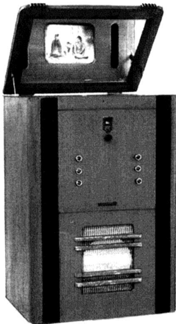
Bild 12: Prototyp eines FS-Empfängers mit Spiegelbetrachtung; Toshiba, 1939.
